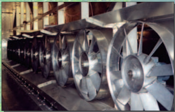
Ventilatori di diametro 100 cm per ottima distribuzione del vapore e con elevata resa con bassi consumi – predisposti tra le cataste
